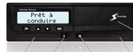
Lecteur de carte conducteur 1 Bouton conducteur 1 Bouton conducteur 2 Lecteur de carte conducteur 2 Cassette à papier
