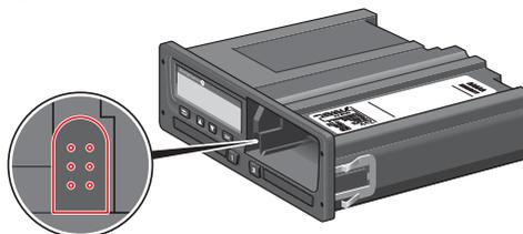
3. Descarregar os dados de acordo com as instruções no equipamento de descarregamento. Garantir que a ignição está ligada ao iniciar o descarregamento.
