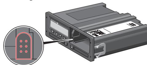
3. Téléchargez les données conformément aux instructions figurant sur le dispositif de téléchargement. Vérifiez que le contact est établi en lançant le téléchargement.
