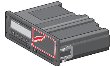
2. Segurar a extremidade inferior do painel e, cuidadosamente, retirar a gaveta da impressora.
