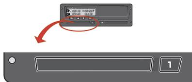
Имеется два картоприемника для вставки карты водителя.
