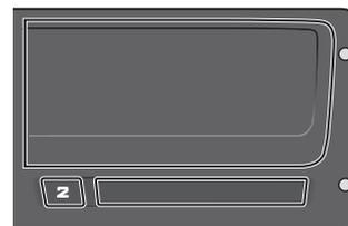
Позади панели принтера располагается принтер с кассетой, в которой находится бумажный рулон. Принтер используется, например, для распечатки информации, хранящейся в тахографе. Бумага с распечаткой выходит из устройства через небольшое отверстие в нижней части панели принтера.
