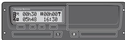
Тахограф также называется «Автомобильным устройством (АУ) – тахографом». Помимо тахографа, автомобиль оснащается датчиком движения, который подключается к автомобилю и тахографу. Дополнительную информацию о датчике движения и его подключении к автомобилю см. в пунктах пункт **Датчик движения** на странице 9 и пункт **Подключение к приборной панели** на странице 9
