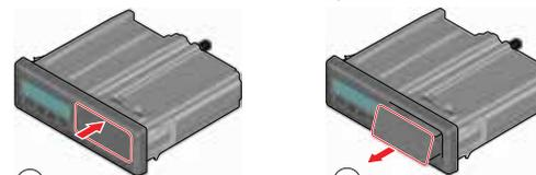
2. Reliez le dispositif de téléchargement au tachygraphe par le connecteur de téléchargement à 6 broches.
