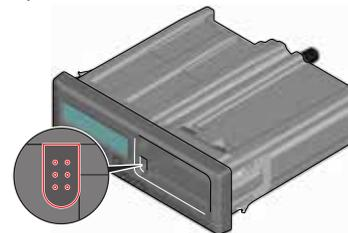
3. Считайте данные согласно инструкции по эксплуатации считывающего оборудования. Приступая к считыванию, убедитесь в том, что зажигание включено.
